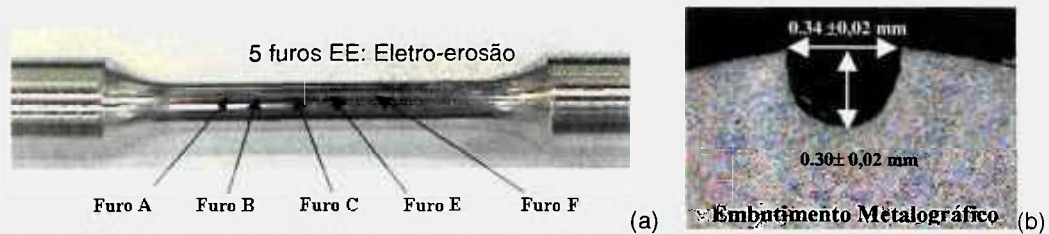
Figura 5.6.2: Simulação da reprodutibilidade dimensional do processo EE. (a) Introdução de cinco defeitos EE na superfície do CP S-N. (b) Esquema da medição dos furos pelo processo metalográfico: corte, embutimento em baquelite, lixamento e medição micrográfica (aumento 50x).
