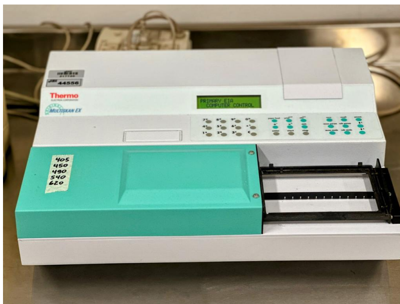
Figura 9 – Equipamento utilizado para a leitura das microplacas testes de ELISA. Multiskan EX (Thermo Scientific).
