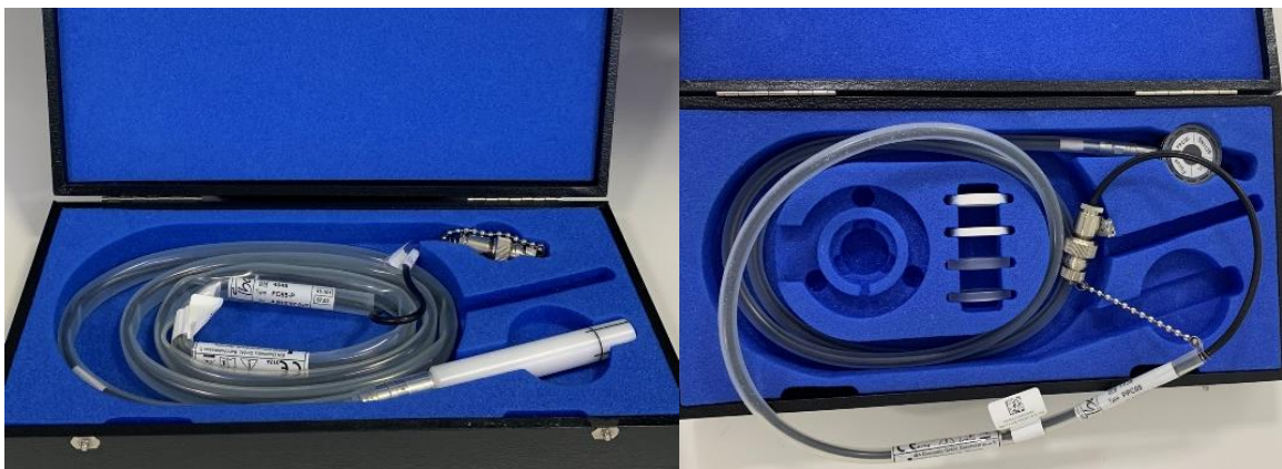
Figura 23- (A) Câmara de ionização modelo IC-15 e (B) Câmara de ionização de placas paralelas modelo PPC05, ambas de fabricação IBA.
