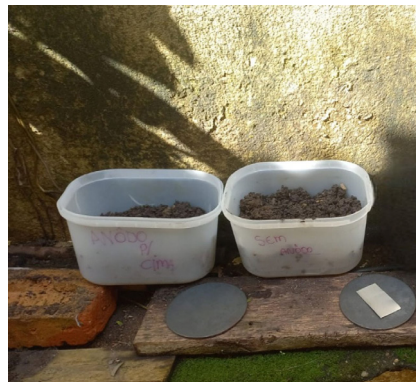
Figura 1. Configuração das chapas de aço-carbono em simulação de dutos subterrâneos e expostas ao ambiente na cidade de Cubatão. Essa configuração repete-se em Praia Grande e São Paulo
