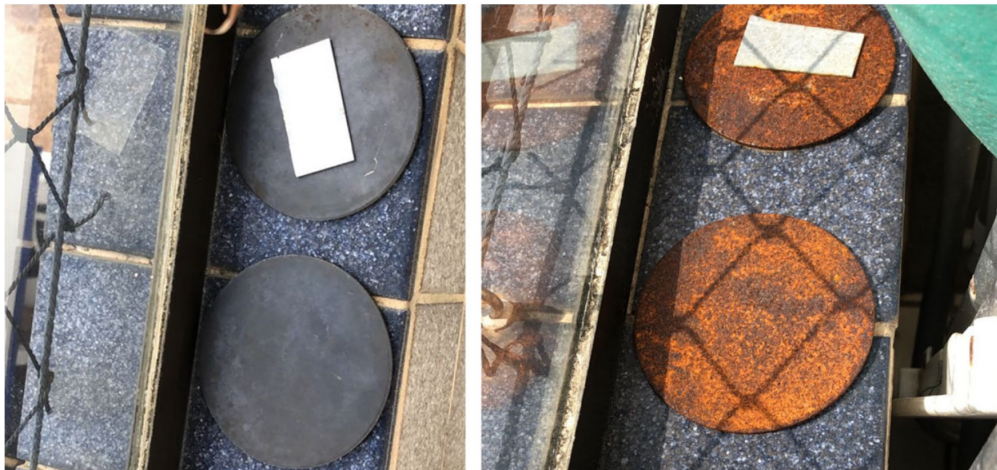
Figura 3. Chapas expostas e enterradas em Praia Grande. A imagem à esquerda retrata as chapas ao começo do experimento e a direita retratam o final do experimento
