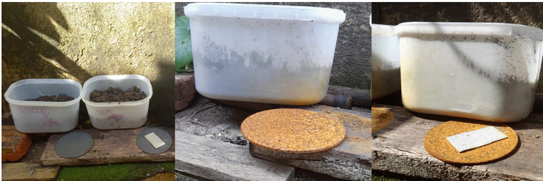
Figura 2. Chapas expostas e enterradas em Cubatão. A imagem à esquerda retrata as chapas ao começo do experimento e as imagens do centro e à direita retratam o final do experimento
