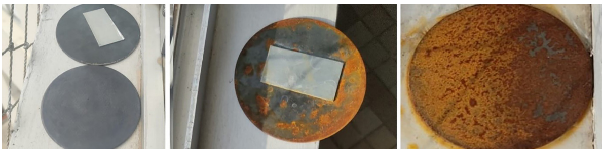
Figura 4. Chapas expostas e enterradas em São Paulo. A imagem à esquerda retrata as chapas ao começo do experimento e as imagens do centro e à direita retratam o final do experimento
