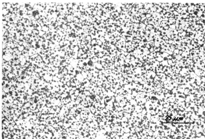
FIGURA 4.9.a. - Micrografia de pastilha constituída de / mistura 5, sinterizada a 1600^{\circ}\text{C} , por 1 hora.
