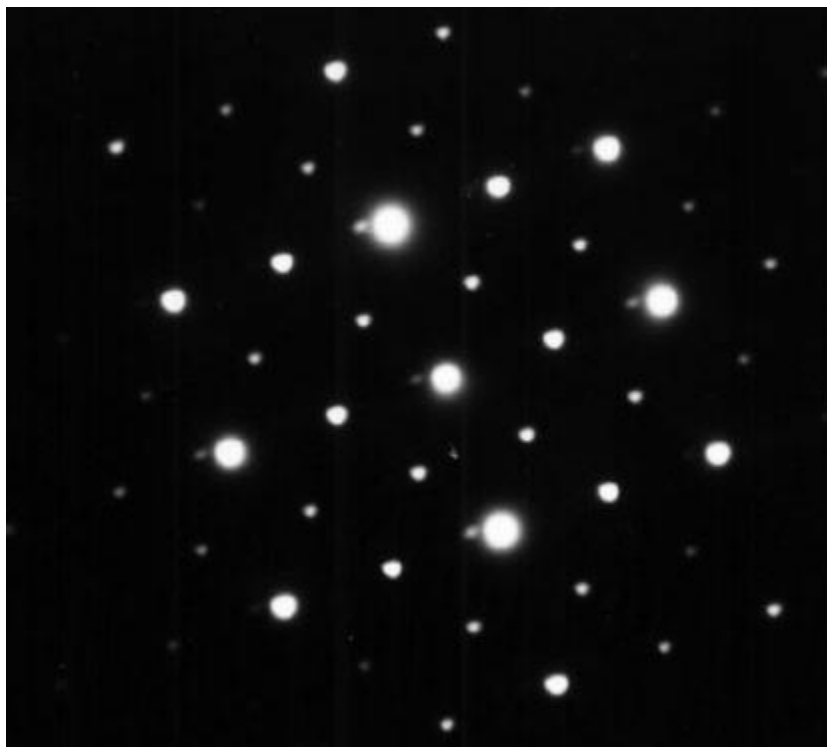
Figura 5. Padrão de difração eletrônica, B=[011] , da liga Fe-30Al-1,6Cr-0,15Zr-0,2B (% at.) laminada a quente e tratada termicamente a 1000 °C por 1 hora.
