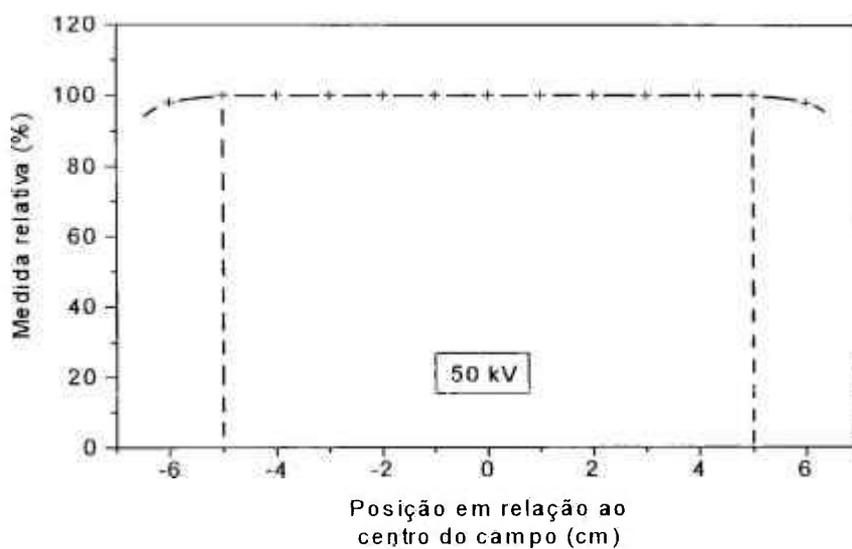
Figura 4.5a - Uniformidade do campo de raios-X obtida com filmes, no plano horizontal, para diferentes qualidades
