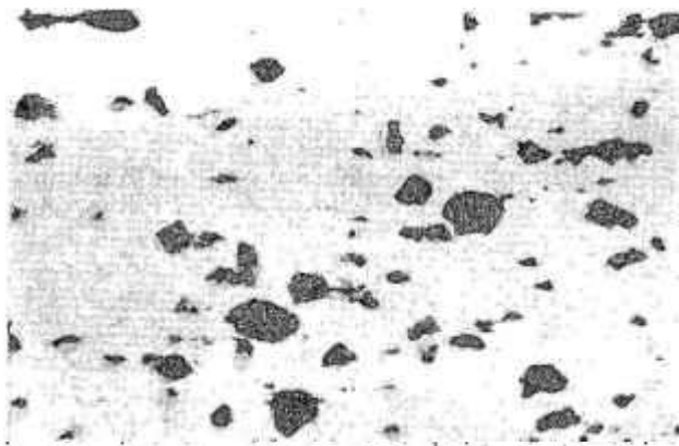
Fig. 3 — Seção transversal de placa combustível utilizando dispersão com 25% de U_2O_3 em alumínio. O U_2O_3 havia sido elutriado em água, a fim de separar partículas menores, existente em dispersões no qual o U_2O_3 não foi elutriado. Aumento: 80 X.
