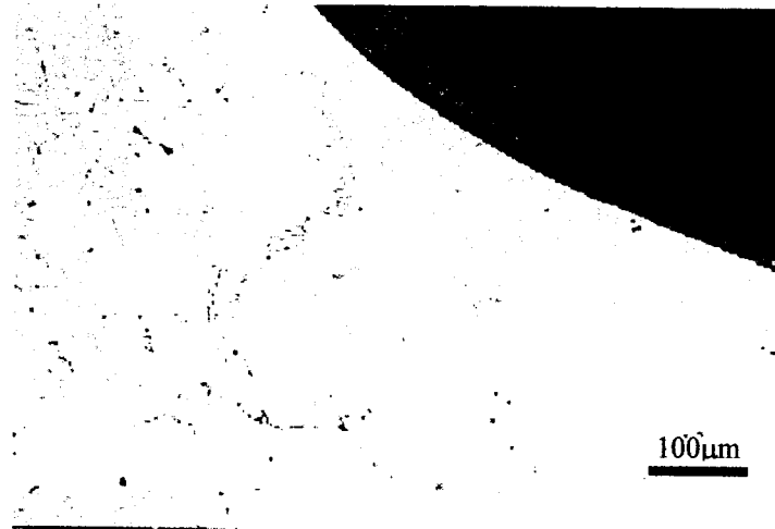
Figura 49 – Micrografia da região a, mostrando carbonetos.
