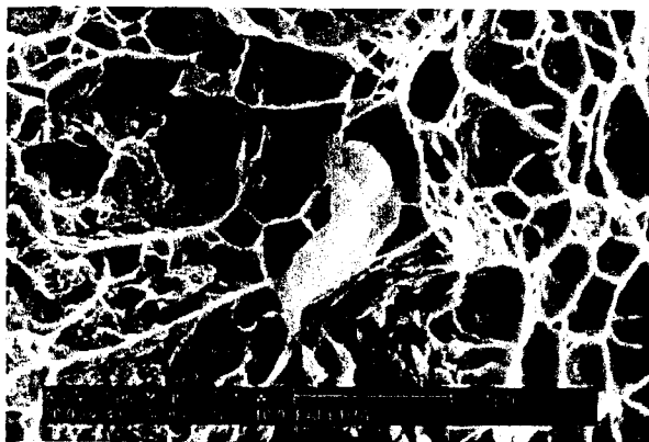
Figura 85 – Fractografia por MEV, com um aumento de aumento de 3000x da amostra CP-7. (ER309L com purga, rompeu no metal de solda)
