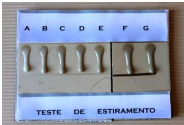
Figura 5: Comparação do escorrimento entre a frita padrão e as contendo os resíduos estudados.
