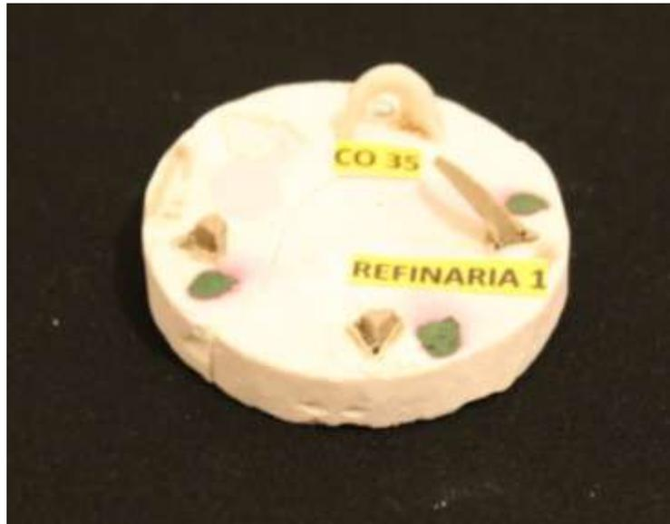
Figura 4: Corpo de prova do ensaio para determinação da refratariedade simples.
