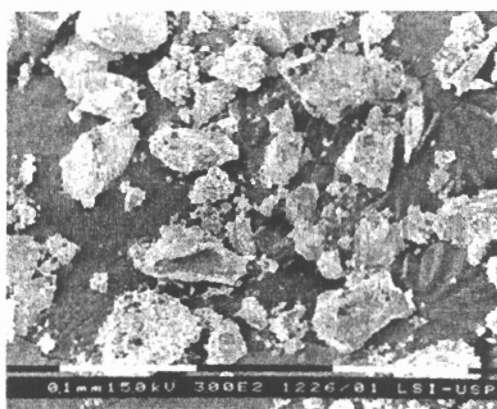
Figura 2. Micrografia (MEV) da liga \text{SmCo}_5 da Alfa Products.
