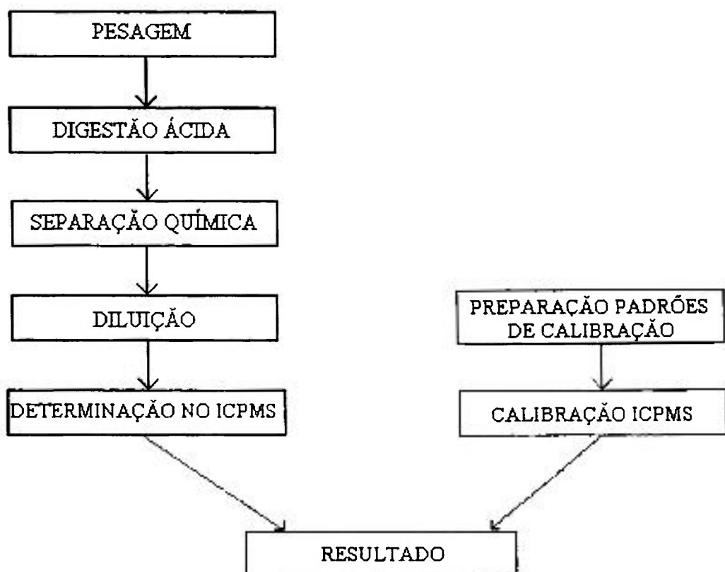
Figura 28. Etapas do procedimento de medição utilizado na determinação da concentração elementar nas soluções de amostra de compostos de urânio
