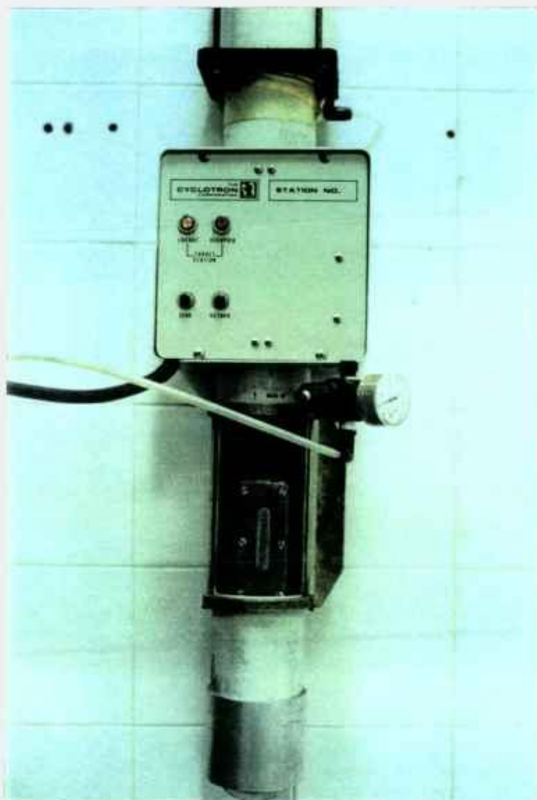
Figura 3.12 - "Coelho" com porta-alvo na cela de manipulação.
