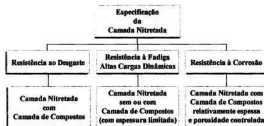
2.13 – Especificação da camada nitretada de acordo com o objetivo da aplicação [4].
