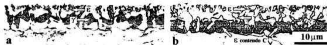
Figura 2.34 - Ferro nitrocarbonetado em banho de sais a 570° por 30 minutos. Ataque: a) Nital 1% Modificado, microscopia por contraste de fase positivo; b) Nital 1% Modificado seguido pelo reagente de Murakami (iluminação em Campo Claro) [27].
