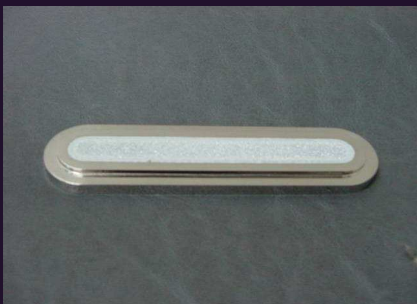
Figura 3. Zn Eletrodepositado em Placa Ni/Cu
