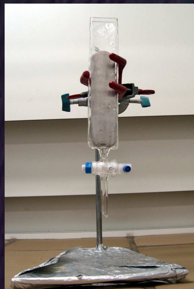
Figura 2. Dissolvedor com placa de Ni/Cu
