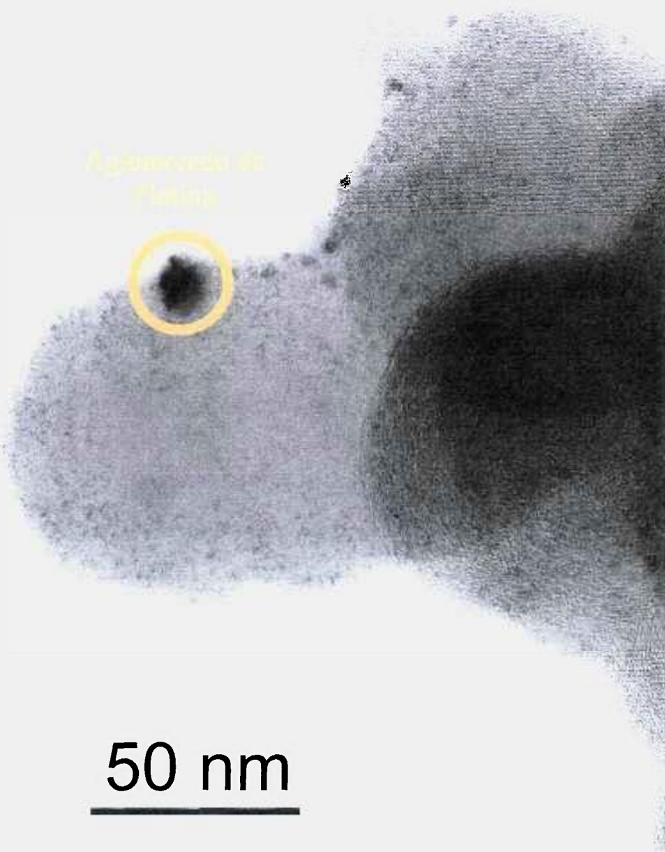
Figura 44: Micrografia de transmissão de um aglomerado de Pt, com tamanho médio de cristalito da ordem de 13,8 nm do sistema PtRuMoNi.
