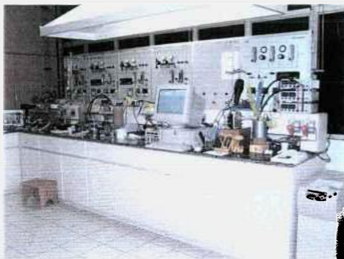
Figura 28: Bancada de teste de células a combustível tipo PEMFC do IPEN.
