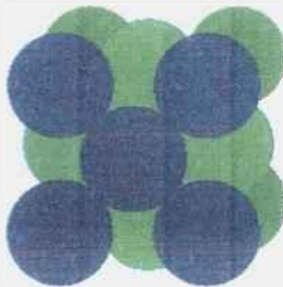
Figura 5: Superfície (100) de uma célula unitária CFC
