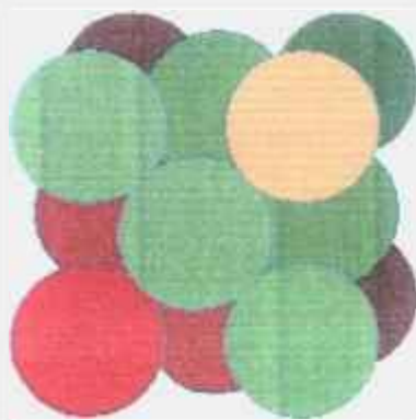
Figura 2: Camadas compactas da estrutura CFC
