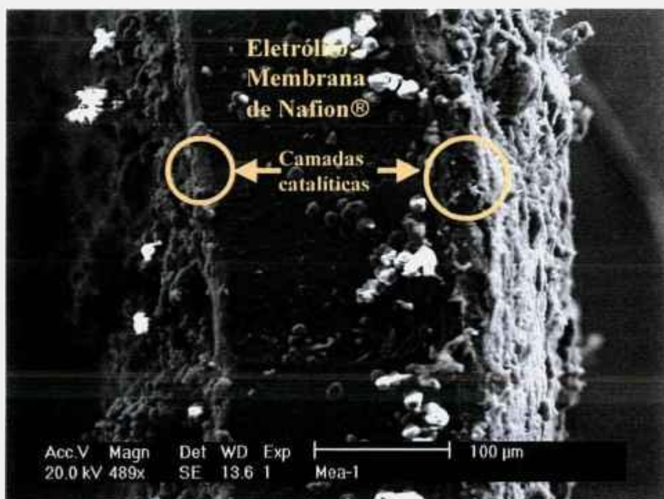
Figura 47: MEA cortado apresentando a estrutura do eletrodo de difusão gasosa.
