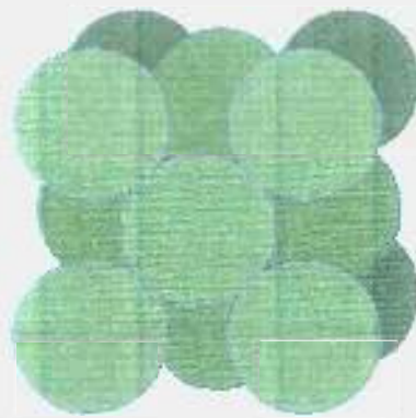
Figura 1: A estrutura CFC
