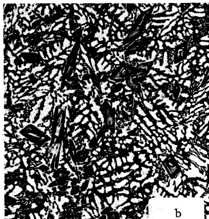
Fig. 9 - Formas e distribuições típicas das estruturas de solidificações na periferia (a,c,e) e no centro (b,d,f) em lingotes de liga Al-18,65% U (a,b); Al-30% U (c,d); e Al-45% U (e,f), revelando segregação inversa do urânio. Aumentos: c, d, e, f - 80X; a - 400X; b - 200X. Redução de 10%.
