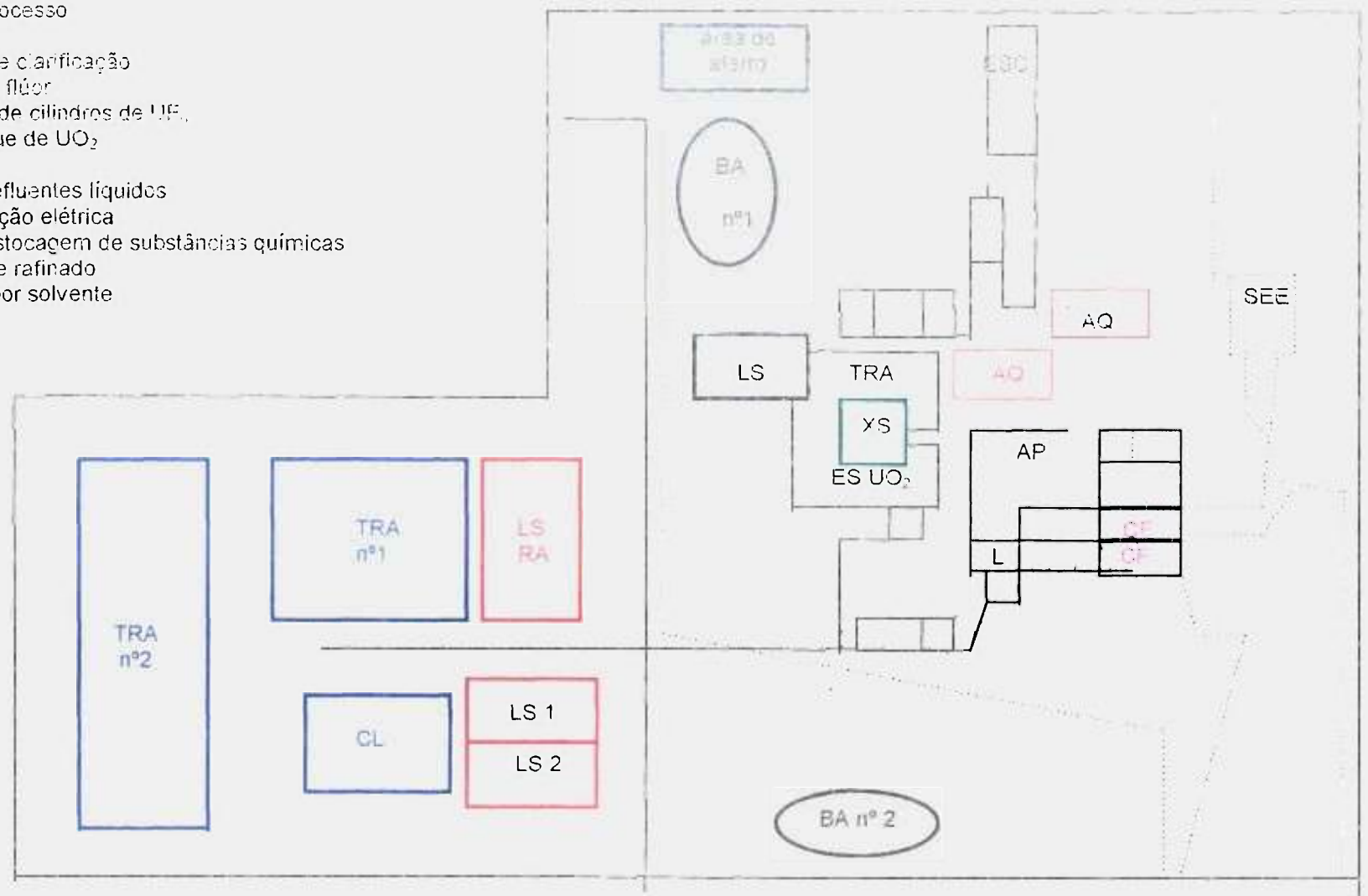
Figura 3.2: Layout da instalação de conversão por solvente
