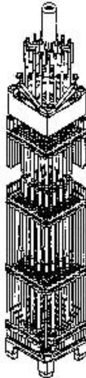
Figura 7.1.2: Elemento Combustível Típico de PWR.
