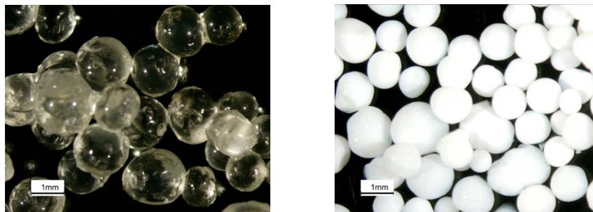
Figura 6: Microesferas fervidas (5 vezes por 10 minutos) (a) não calcinada (b) calcinadas a 1000 °C por 60 minutos
