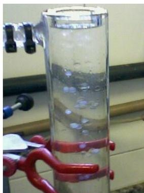
Figura 1: Coluna de vidro utilizada para a obtenção de microesferas por gelificação interna
