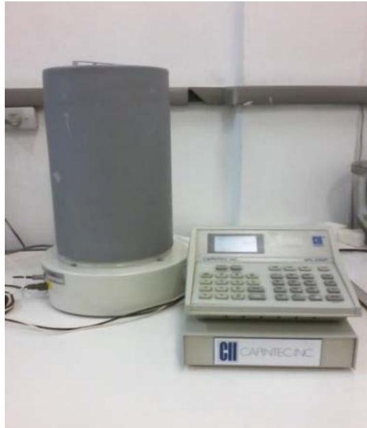
Figura 1. Ativímetro de referência do Laboratório de Calibração de Instrumentos, Capintec, modelo NPL-CR
