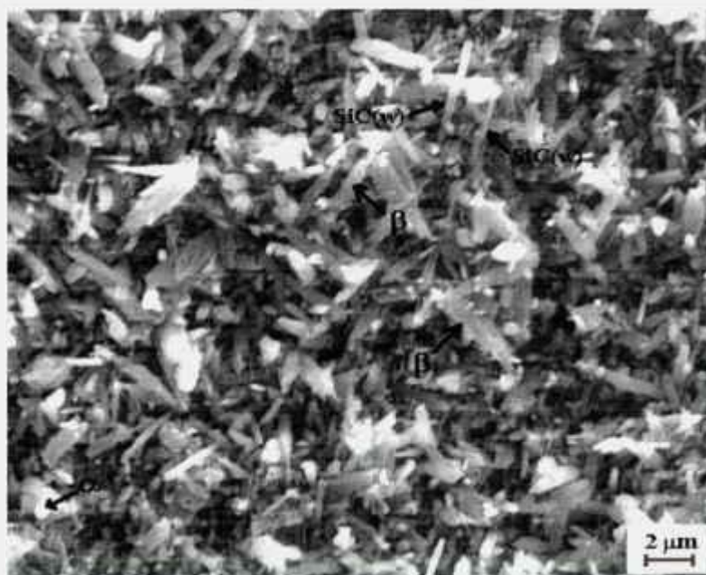
Figura IV.26 – Fotomicrografia da composição C (92,5Y2,5Y10W), sinterizada por prensagem uniaxial a quente. Observa-se a presença de grãos \alpha\text{-Si}_3\text{N}_4 e \beta\text{-Si}_3\text{N}_4 (predominantes) e \text{SiC}_{(w)} .
