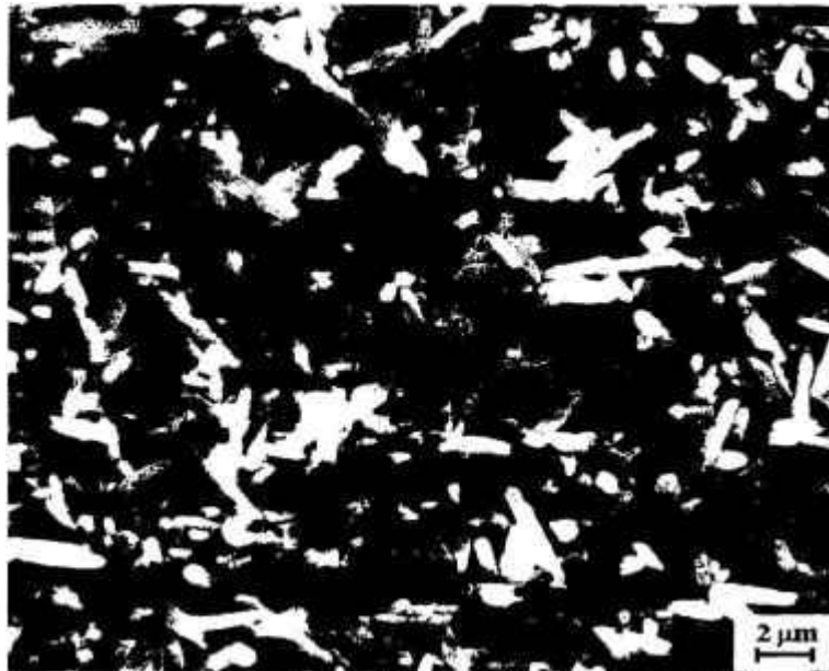
Figura IV.23 – Fotomicrografia da composição B (90N5Y), sinterizada por prensagem uniaxial a quente, evidenciando a predominância de grãos \beta - \text{Si}_3\text{N}_4 .
