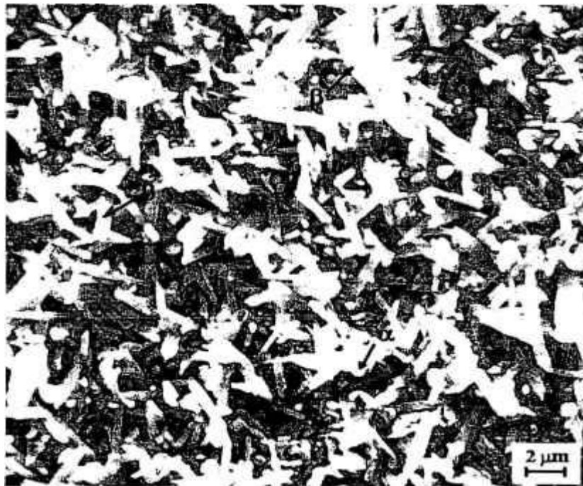
Figura IV.21 – Fotomicrografia da composição B (90N5Y), obtida por sinterização normal. Observa-se uma microestrutura com predominância de grãos \beta - \text{Si}_3\text{N}_4 .
