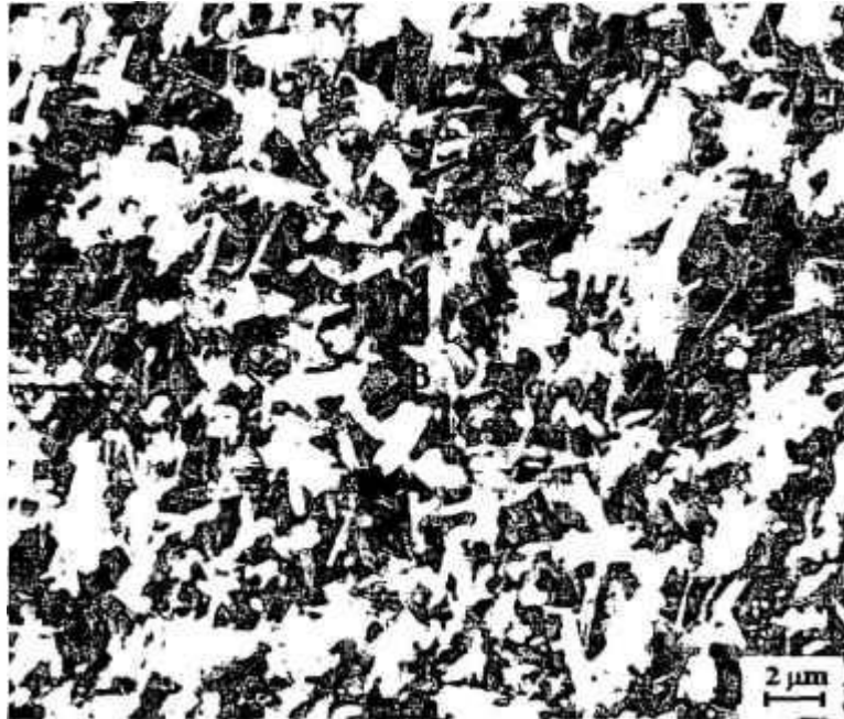
Figura IV.31 – Fotomicrografia da composição H (90N5Y30W), sinterizada por prensagem uniaxial a quente.
