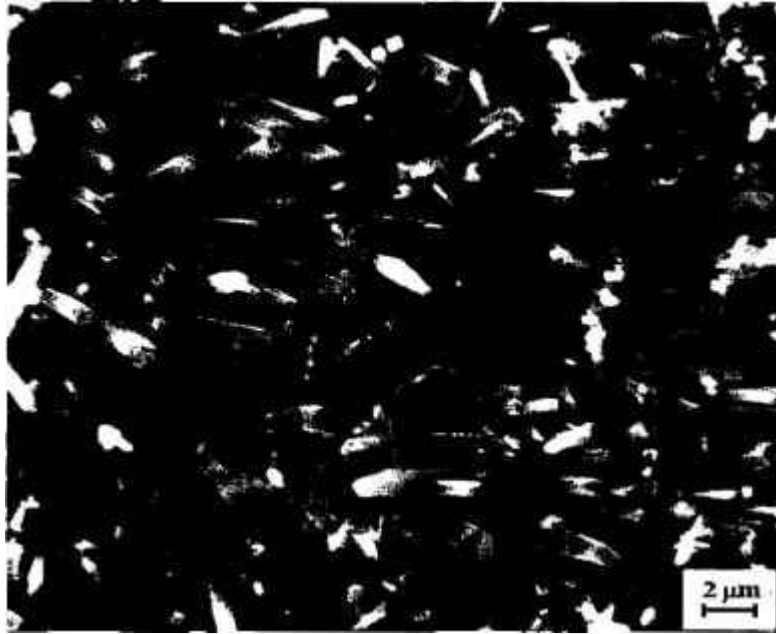
Figura IV.29 – Fotomicrografia da composição F (90N5Y20W), sinterizada por prensagem uniaxial a quente, observando-se uma predominância de grãos \beta -Si 3 N 4 , com SiC (w) distribuídos homogeneamente na microestrutura e orientados na direção normal ao eixo de prensagem.
