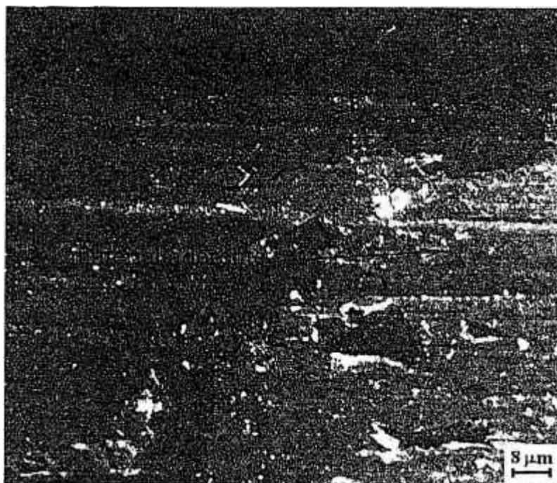
Figura IV.52 - Superfície de desgaste da composição B (90N5Y), evidenciando a presença de material aderente.
