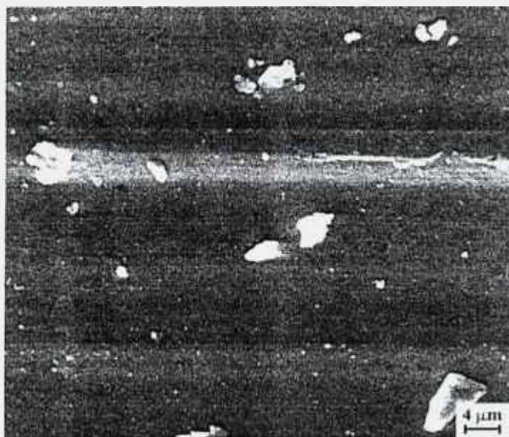
Figura IV.57- Superfície de desgaste da composição F(90N5Y20W), onde observa-se algumas partículas de ferro fundido, provenientes das reações triboquímicas pino contra disco.
