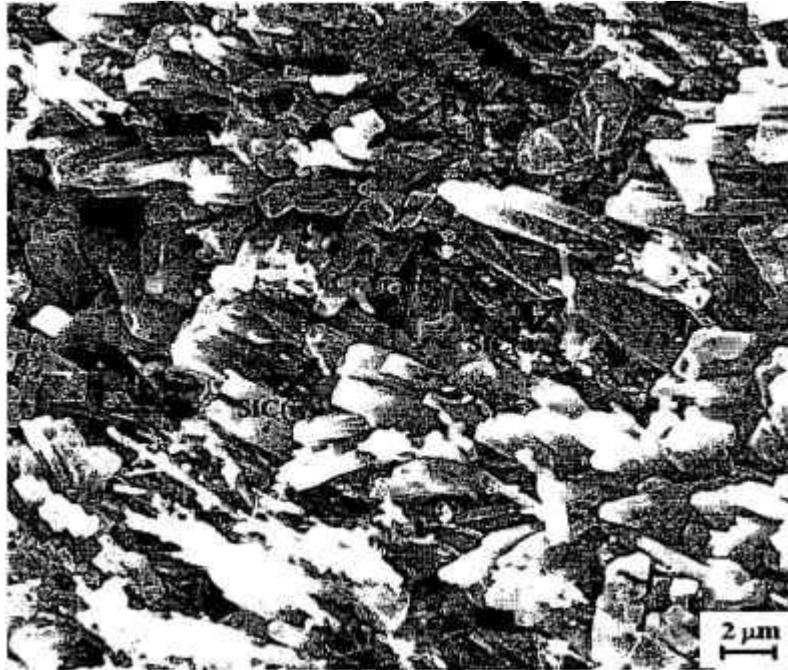
Figura IV.27 – Fotomicrografia da composição D (90N5Y10W), sinterizada por prensagem uniaxial quente, mostrando uma microestrutura com predominância de grãos \beta - \text{Si}_3\text{N}_4 , e algumas regiões com aglomerados de \text{SiC}_{(w)} .
