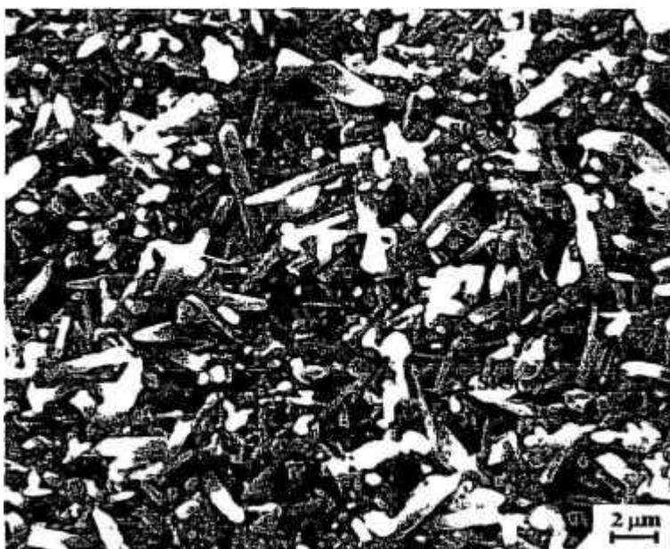
Figura IV.25 – Fotomicrografia da composição D (90N5Y10W), obtida por sinterização normal. Observa-se uma microestrutura com grãos \alpha\text{-Si}_3\text{N}_4 , \beta\text{-Si}_3\text{N}_4 (predominante) e \text{SiC}_{(w)} .
