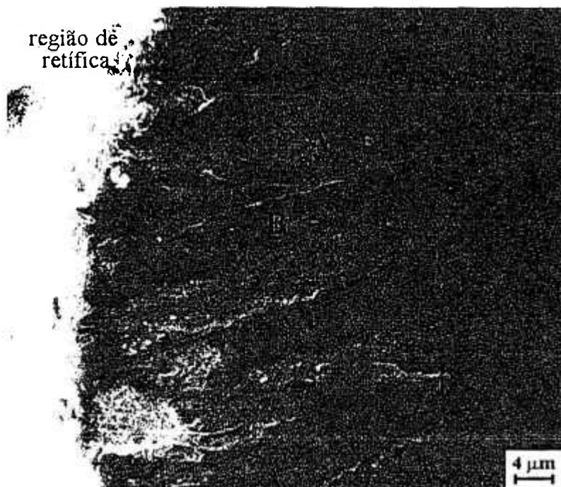
Figura IV.53 - Superfície de desgaste da composição C (92,5N5Y10W). Observa-se regiões com material aderente (ponto A) de aspecto escamoso, associado ao desenvolvimento de microfissuras perpendiculares à direção de deslizamento (ponto B).
