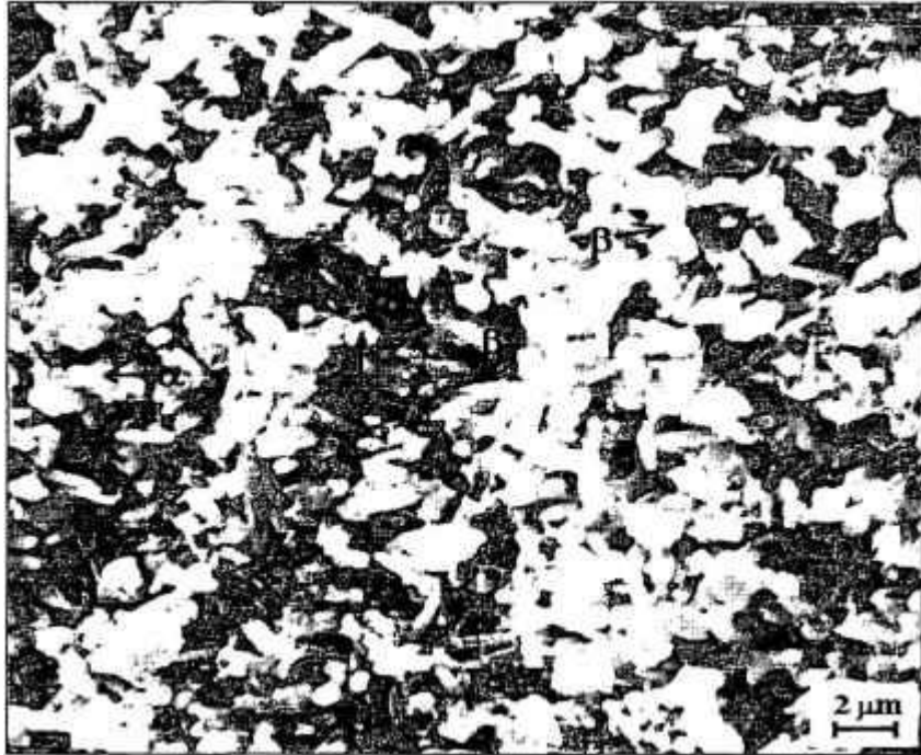
Figura IV.20 - Fotomicrografia da composição A (92,5N2,5Y), obtida por sinterização normal , mostrando uma microestrutura com grãos \alpha - \text{Si}_3\text{N}_4 (formato equiaxial) e \beta - \text{Si}_3\text{N}_4 (formato alongado).
