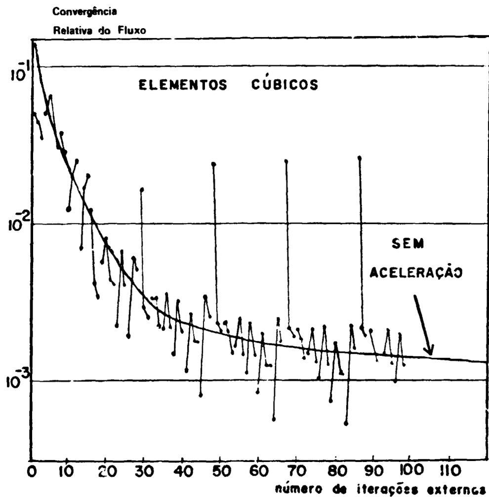
Figura 2 - Comparação entre o programa FERM sem aceleração com o programa FERM acelerado pelo esquema de Relanceamento Zonal.
