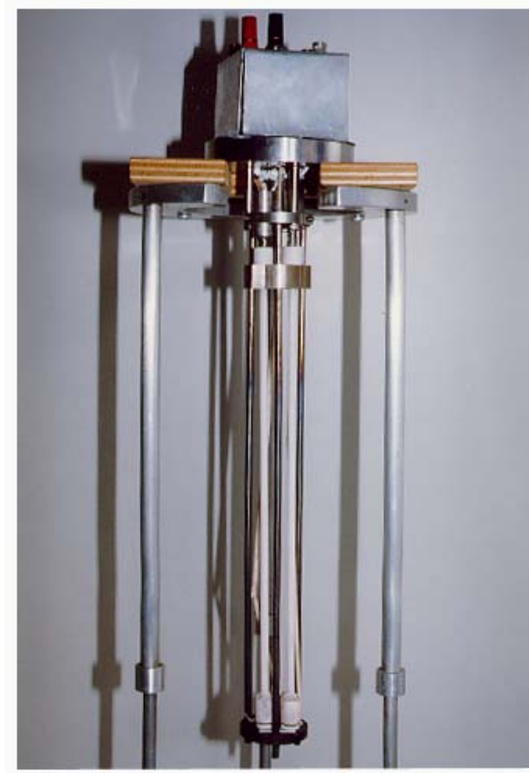
Figura 2.2: Câmara porta-amostras para as medidas de espectroscopia de impedância.
