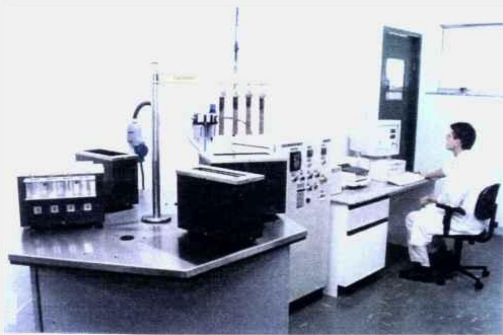
FIGURA 13 – Foto do equipamento para ensaio "Dip-Dry", pertencente à Acesita S. A..
