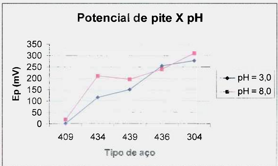
FIGURA 40 – Gráfico comparativo com os valores de potencial de pite obtidos em solução 3,5% (massa) NaCl, em pH = 3,0 e em pH = 8,0, dos aços inoxidáveis ensaiados.
