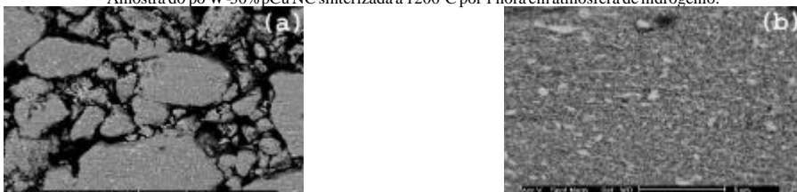
Figura 4. Micrografias de MEV das amostras do pó W-30%pCu NC sinterizadas a 950°C por 0 min., com taxa de aquecimento de 10°C/min. e em atmosfera de H 2 : a) porosidade interconectada e b) região interna da partícula do pó.
