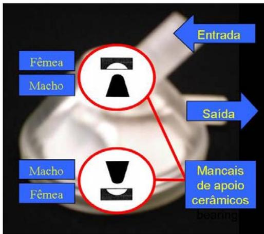
Figura 1. Posicionamento dos mancais de apoio cerâmicos na Bomba Centrífuga Implantável.
