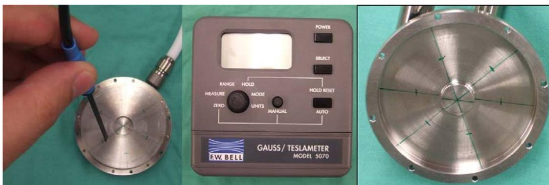
Figura 2. Marcação dos pontos obtidos pela medição com Gaussímetro.
