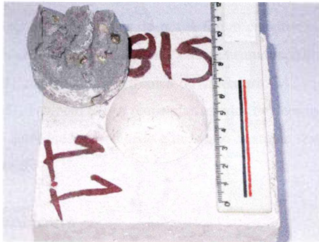
Figura 4.1 – Fotografia mostrando um corpo-de-prova, como exemplo, utilizado no “ cup test ”.
