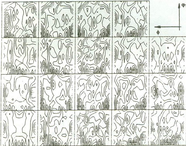
Figura 6 - Função distribuição de orientações em secções constantes de \varphi_1 para a amostra tratada termicamente a 800^{\circ}\text{C}/1\text{h} .
