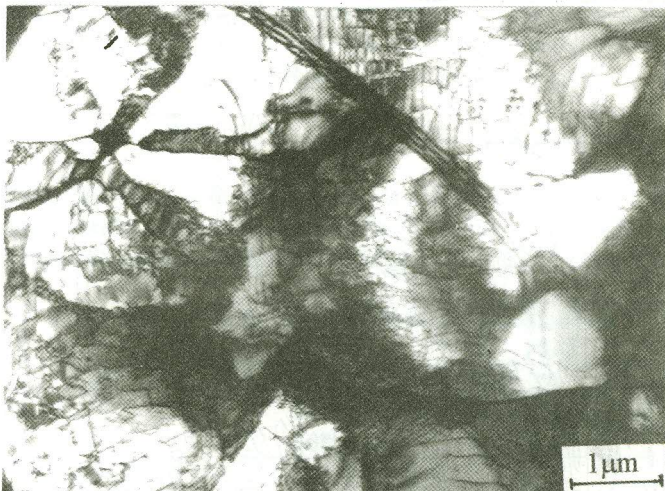
Figura 5 - Micrografia obtida por MET da amostra tratada termicamente a 800°C/1h.
