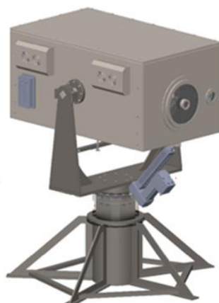
Figura 2 - Projeto FAMES: invólucro de proteção para zona explosiva e área de instalação
