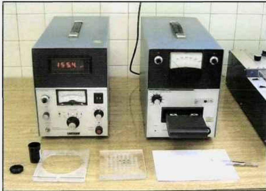
FIGURA 3.10 Sistema leitor TL, Harshaw Nuclear Systems, modelo 2000A, acoplado ao pico amperímetro, modelo 2000B.
