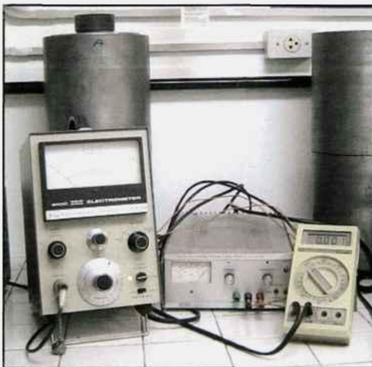
FIGURA 3.3 Activímetro desenvolvido no IPEN, câmara de ionização de placas paralelas, do tipo poço, acoplada a um eletrômetro Keithley.
