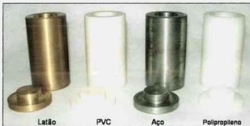
FIGURA 3.9 Conjunto de absorvedores utilizados: latão, PVC, aço e polipropileno, desenvolvido inicialmente por Dytz e Caldas [2001].
