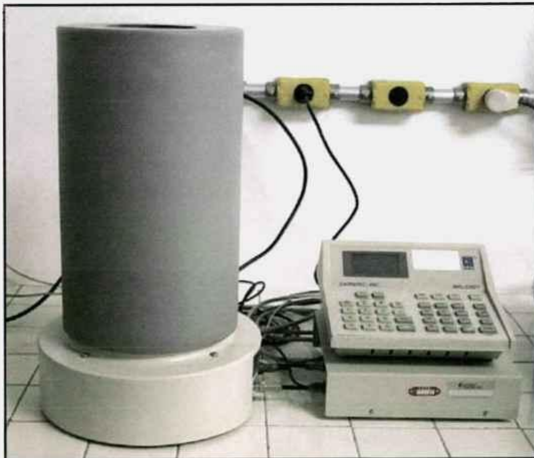
FIGURA 3.1 Activímetro padrão secundário com câmara de ionização tipo poço e módulo de leitura Capintec, modelo CRC ® -15R.
