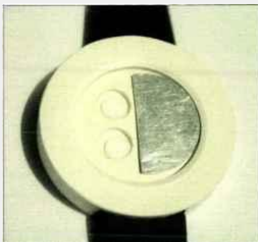
FIGURA 4.76 Porta-dosímetro, com aro de PVC, com filtro de 0,5 mm Al para determinação da contribuição da radiação gama.
