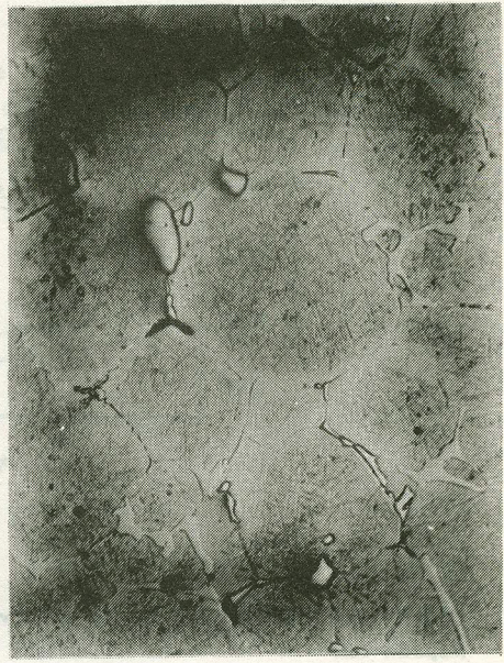
Figura 5. Aço Rápido N° 2 Sinterizado a 1240°C sob vácuo por 2h com adição de (a) 0.1%C, (b) 0.2%C, (c) 0.3%C e (d) 0.4% C. Ataque Nital + Picral. 420 X.
