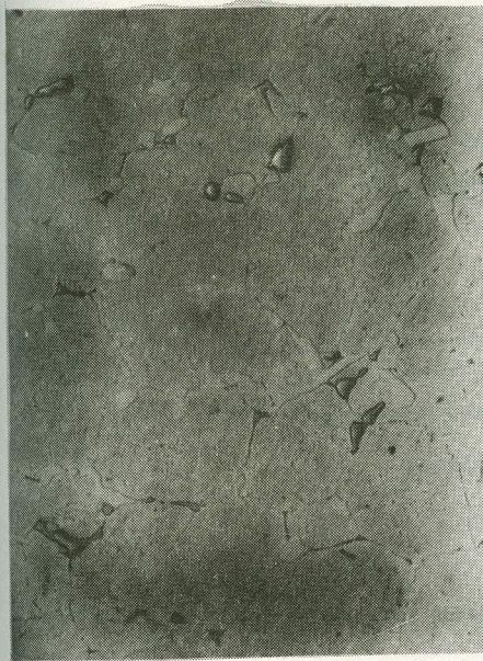
Figura 5. Aço Rápido N° 2 Sinterizado a 1240°C sob vácuo por 2h com adição de (a) 0.1%C, (b) 0.2%C, (c) 0.3%C e (d) 0.4% C. Ataque Nital + Picral. 420 X.
