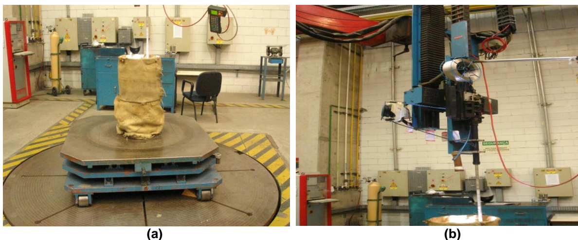
Figura 3: Montagem da peça no equipamento de soldagem - (a) Imagem da base de giratória de apoio do anel e (b) Imagem do mecanismo automático de alimentação do arame (material de adição).
