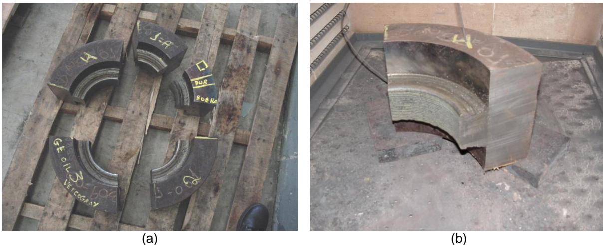
Figura 7: (a) Amostras seccionadas em cinco partes respectivamente denominadas por 1A, 1B, 2, 3 e 4. (b) Imagem da montagem das peças para o tratamento térmico de alívio de tensões com indicação do termopar de contato na amostra. Tratamento sem atmosfera controlada.
