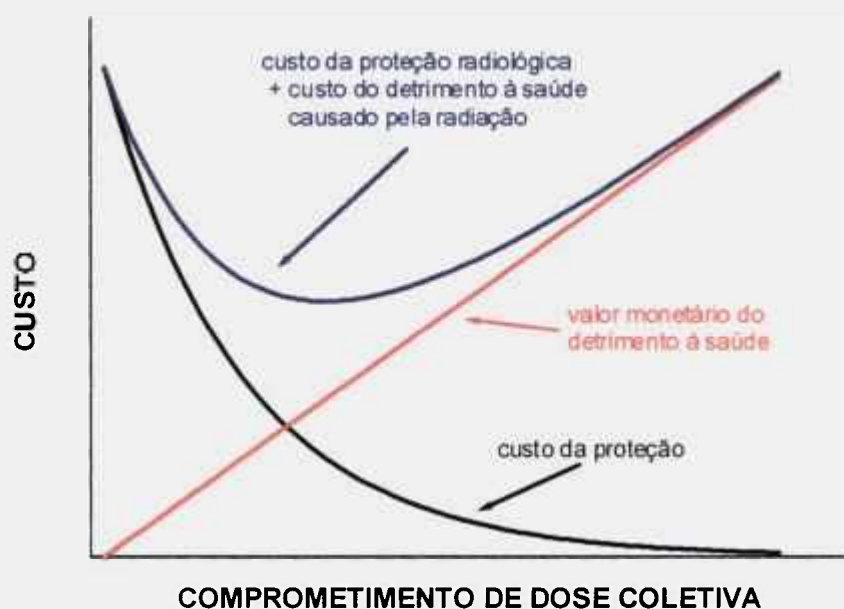
Figura 2-1 - Curvas típicas relacionando custo da proteção radiológica à dose coletiva em uma determinada população. Neste gráfico, a curva preta corresponde ao decréscimo do custo da proteção com o aumento do comprometimento de dose coletiva; a curva vermelha propõe uma relação linearmente crescente entre o valor monetário do dano e o comprometimento de dose coletiva; a curva azul representa a soma das duas curvas anteriores(22).
