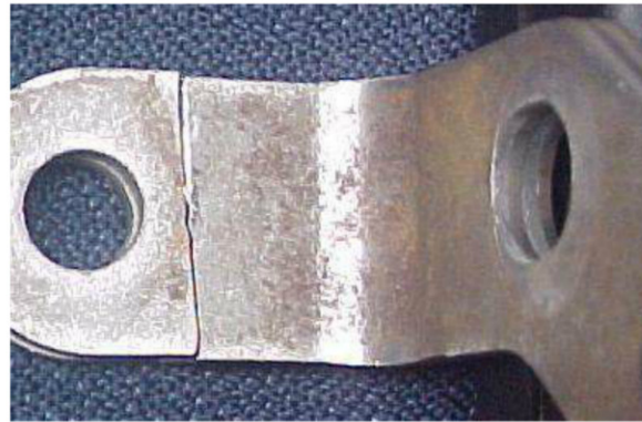
Figura 20: Região onde ocorre a falha no suporte de aço S260NC.
