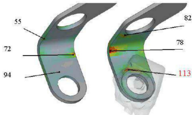
Figura 15: Resultado da análise estática de pressão no bocal do tubo de admissão de ar do aço S700MC.
