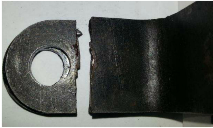
Figura 25: Região onde ocorre a falha no suporte do aço S700MC, corpo-de-prova 2.
