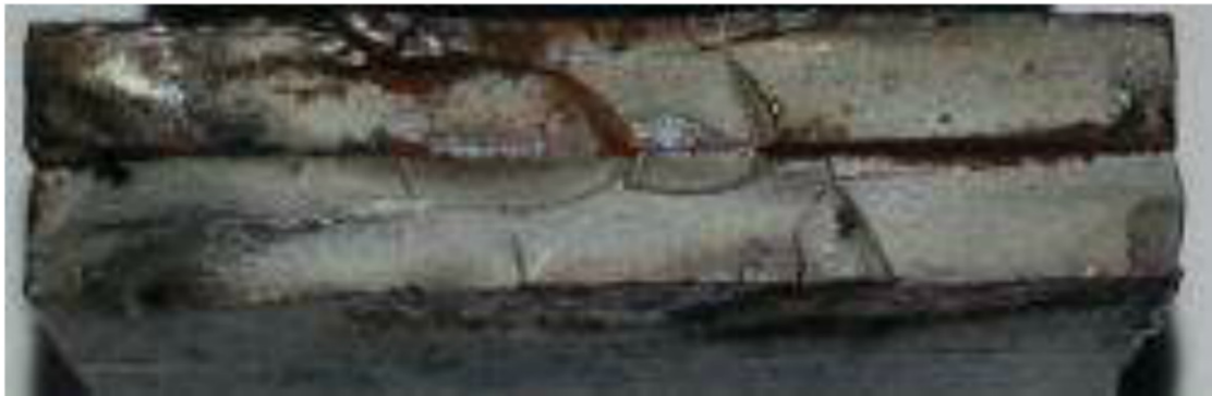
Figura 25: Marcas de catraca, material S700MC, corpo-de-prova 2.
