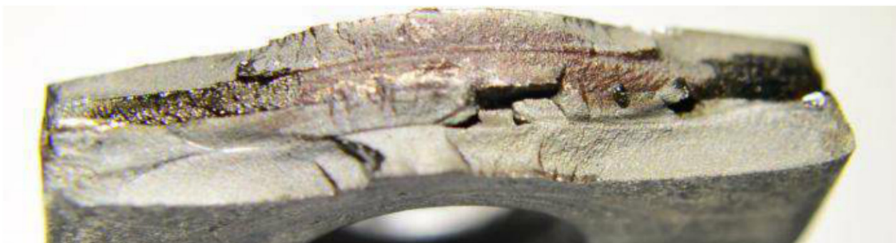
Figura 24: Marcas de catraca, material S260NC, corpo-de-prova 1.
