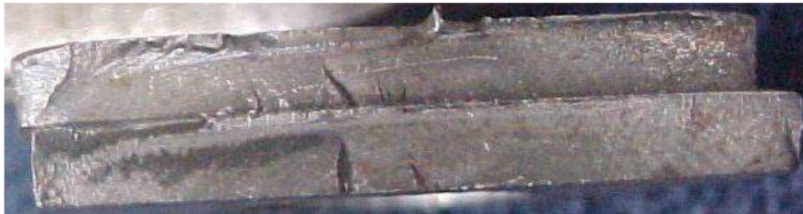
Figura 22: Marcas de catraca no suporte de aço S260NC fraturado em serviço.
