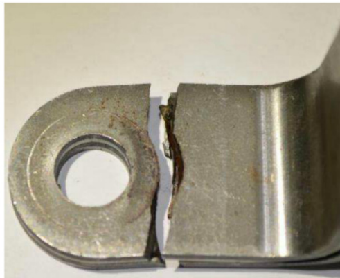
Figura 23: Região onde ocorre a falha no suporte do aço S260NC, corpo-de-prova 1.
