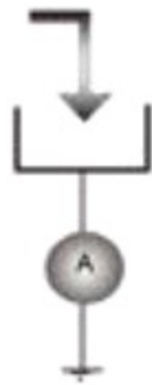
Figura 2: O Copo de Faraday. Íons positivos penetram e se chocam com as paredes do copo metálico. Um amperímetro é interposto entre o copo e o aterramento sendo a corrente eletrônica medida. Esta corrente será proporcional a corrente iônica que penetra no copo.
