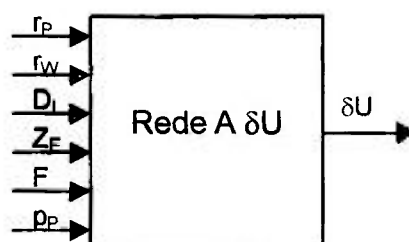
FIGURA 7.11: Esquema adotado para a modelagem do poder de separação \delta U da centrífuga em estudo
