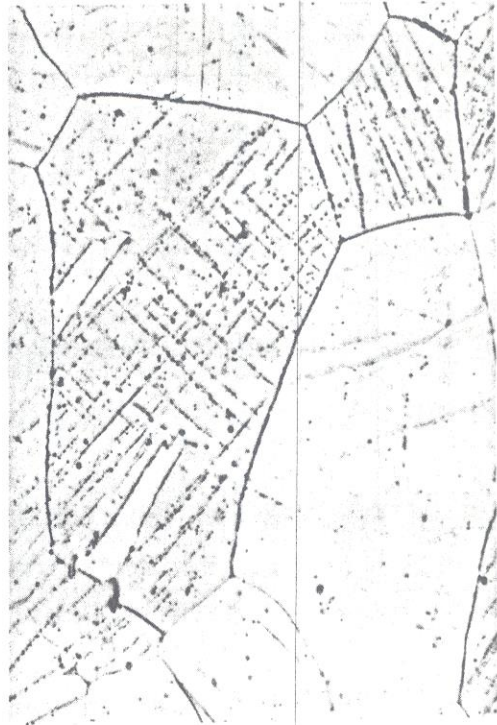
Abb. 43: Gefüge nach 15%kv+973K-1000 Std., V2A-Beize, 1000X
