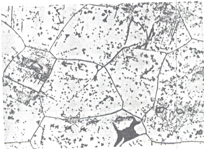
Abb. 23: Gefüge nach 973 K-1000 Std., V2A-Beize, 1000X
