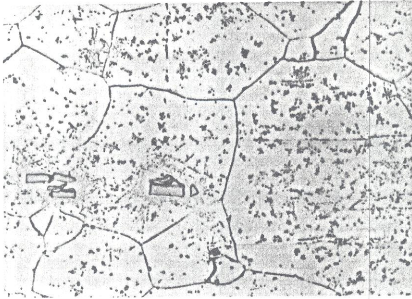
Abb. 24: Gefüge nach 1073 K-1000 Std., V2A-Beize, 1000X
