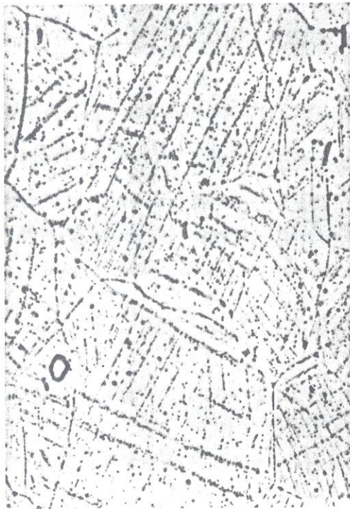
Abb. 44: Gefüge nach 15%kv+1073K-1000 Std., V2A-Beize, 1000X
