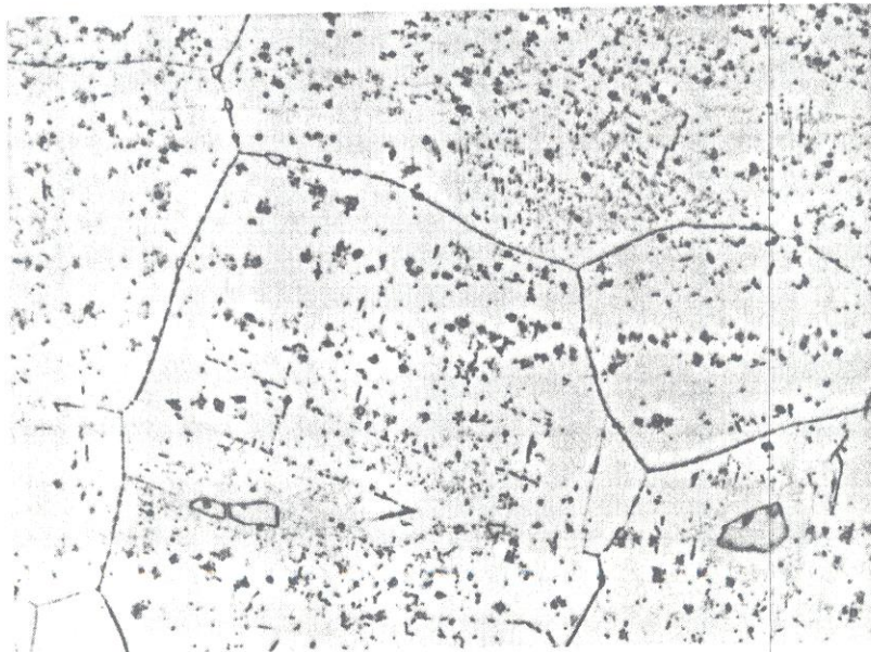
Abb. 25: Gefüge nach 1173 K-1000 Std., V2A-Beize, 1000X
