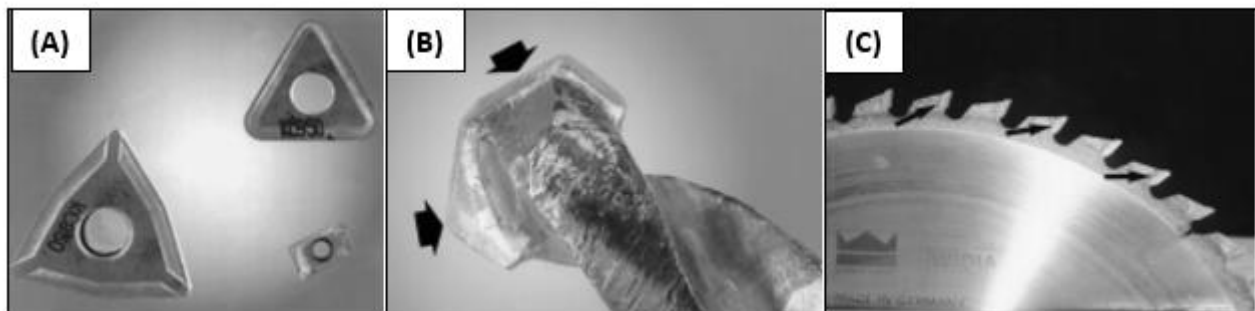
Figura 1. (A) Insertos ou pastilhas de metais-duros; (B) Broca de Widia para perfuração de paredes; e (C) serra de corte com pastilhas de metais-duros soldada no disco de aço.
