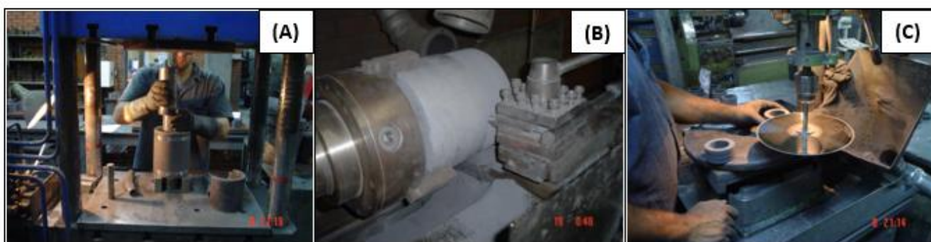
Figura 3. (A) Compactação da mistura de WC-Co; (B) Processo de usinagem da peça a verde (compactado); e (C) manipulação do produto a verde, sem uso do EPI.
