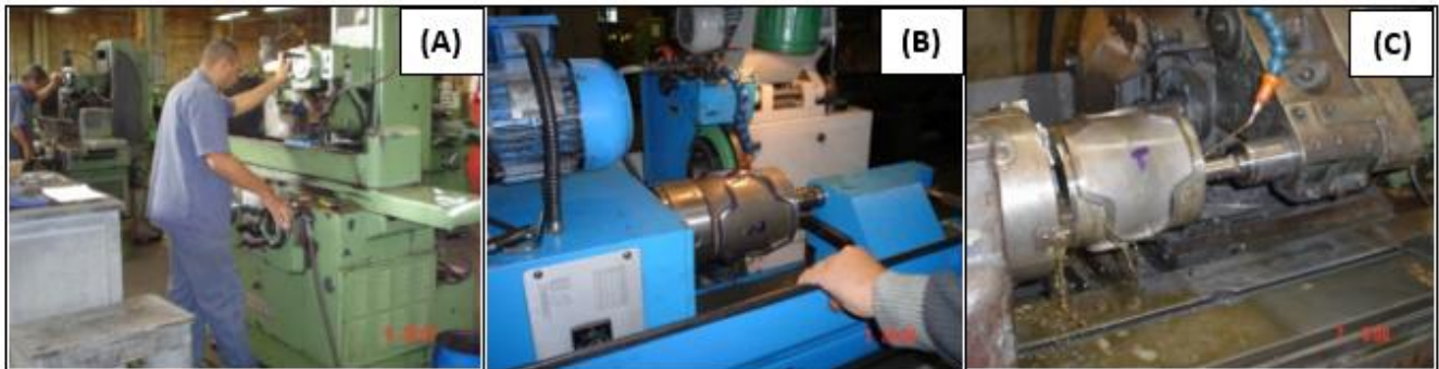
Figura 4. Processo de retificação com refrigeração: (A) retífica plana; e (B) retífica cilíndrica externa; e (C) retífica cilíndrica interna, com uso de óleo solúvel em água (refrigerante).
