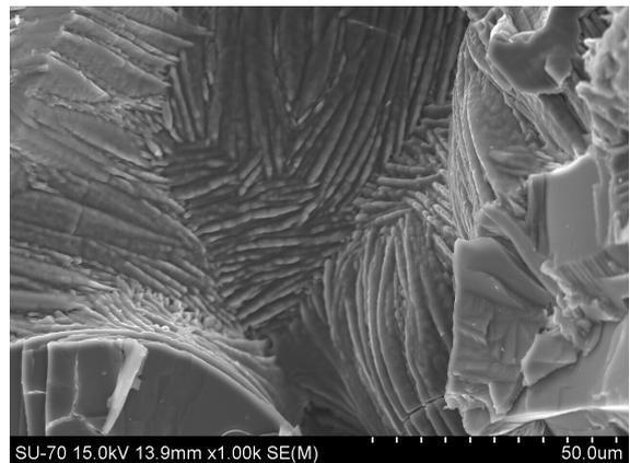
6 (b) - MEV 1.000 x vidro com sílica comercial – fratura – tratado termicamente 840°C
