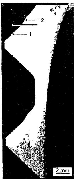
FIGURA 4.2. A área desgastada do braço de trava tem duas regiões como ilustrado por essa seção transversal. A região principal, à frente da extremidade do dente é reta (1); a outra é a região de transição que tem o formato curvo(2).
