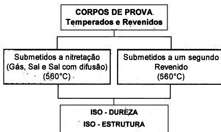
Figura 63 - Metodologia aplicada para obtenção de amostras com iso-dureza e iso-estrutura.
