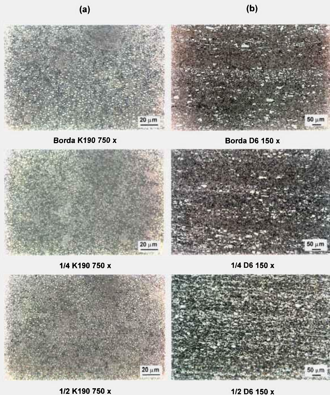
Figura 54- Estrutura do aço sinterizado K190 PM e AISI D6, ambos no estado recozido conforme parâmetro indicado na figura 53. Ataque Nital 2%.
