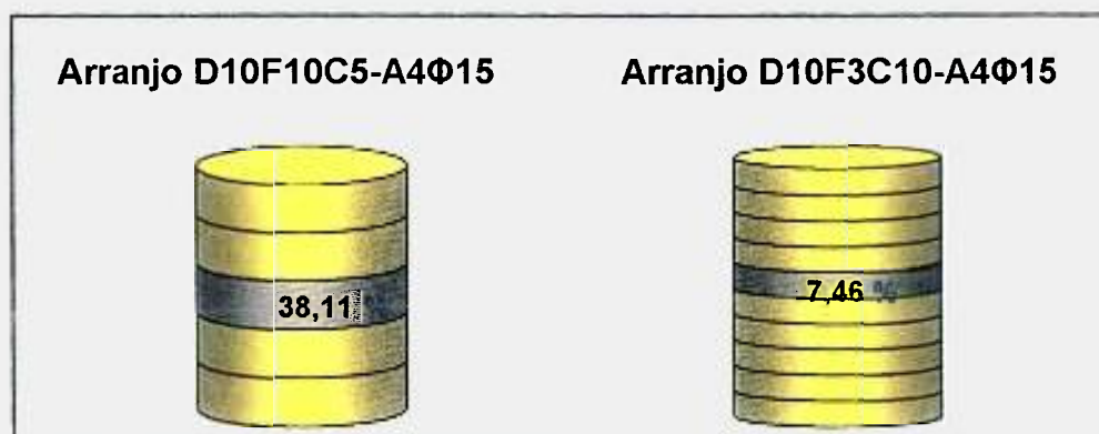
FIGURA 64 Posição das fontes e respectivos desvios percentuais em relação ao valor real para uma fonte posicionada no limite da superfície da 5ª camada do tambor.
