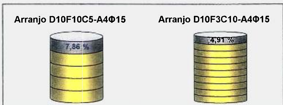
FIGURA 55 Posição e respectivo desvio percentual em relação ao valor real para a fonte posicionada na 1ª camada para os arranjos D10F10C5-A4Φ15 e D10F3C10-A4Φ15
