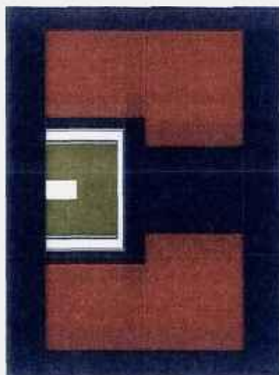
FIGURA 9 Detector HPGe e colimador em corte longitudinal. Cor ocre – cristal de Ge, cor cinza – alumínio, cor branca – vácuo, cor vermelha – colimador de chumbo e cor azul – ar.
