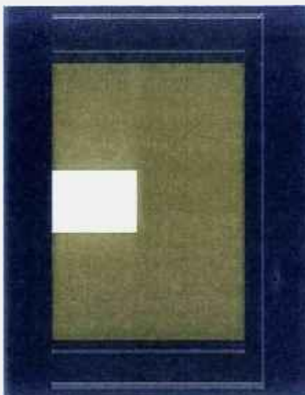
FIGURA 7 Vista lateral do detector. Cor ocre – cristal de Ge, cor cinza – alumínio, cor branca – vácuo e cor azul – ar.
