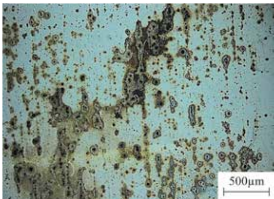
Figura 6- Corrosão localizada na liga AA2198-T851 associada às presença de partículas contituíntes micrométricas na superfície da liga.
