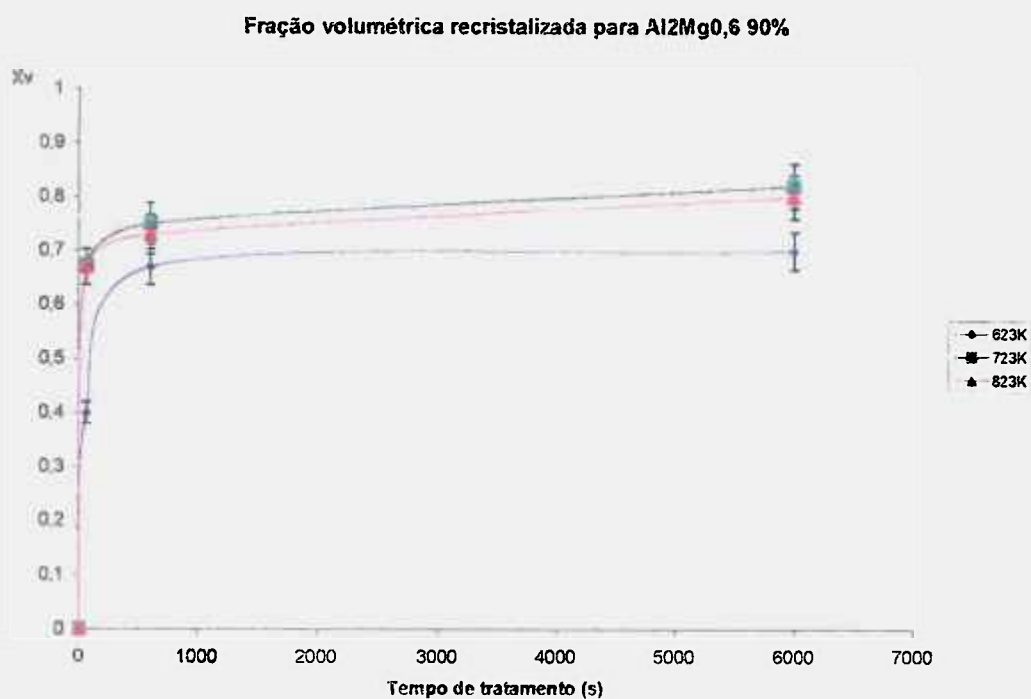
Figura 4.36. Curvas da fração recristalizada X_v em função da temperatura e do tempo de tratamento para amostras da liga Al-2Mg-0,6Zr com 90% de redução em área.
