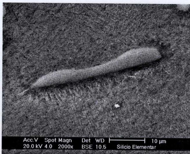
**Fig.115** Micrografia eletrônica de varredura (elétrons retroespalhados) mostrando o silício primário em processo de arredondamento e dissolução.
