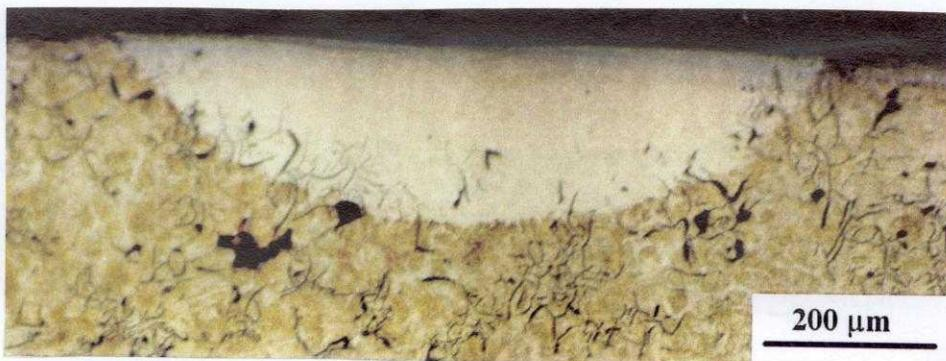
**Fig. 52** MO da seção transversal da área de ferro fundido (condição L2). Ataque: Nital 4%.
