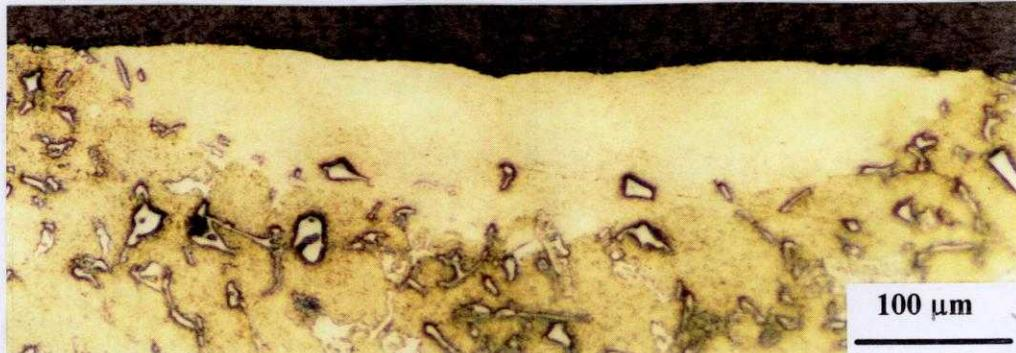
**Fig. 91** MO da seção transversal da área da liga de Al-Si (condição LB). Ataque: HF 5%.
