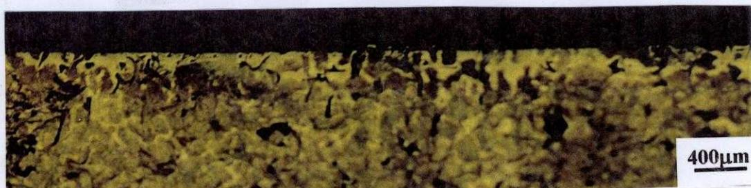
**Fig. 68** MO da seção transversal da área de ferro fundido (condição T4L6).Ataque: Nital 4%.
