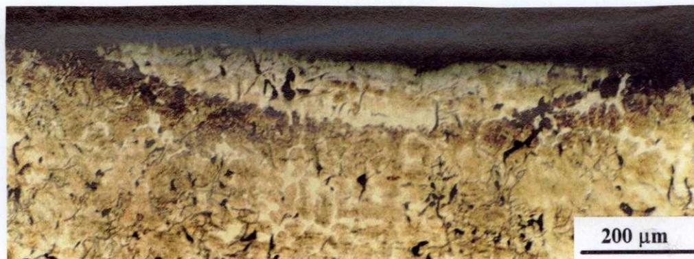
**Fig. 55** MO da seção transversal da área de ferro fundido (condição L5). Ataque: Nital 4%.
