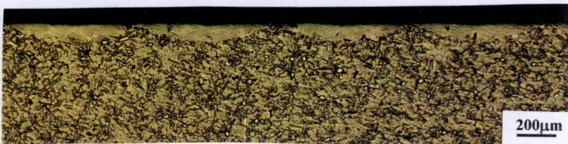
**Fig. 108** MO da seção transversal da área da liga de Al-Si (condição T1LA). Ataque: HF 5%
