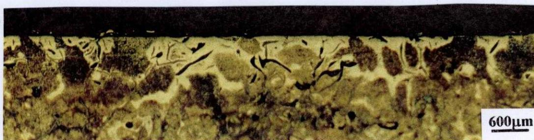
**Fig. 69** MO da seção transversal da área de ferro fundido (condição T5L7).Ataque: Nital 4%.
