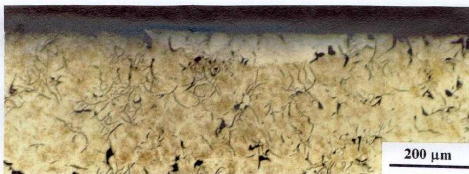
**Fig. 56** MO da seção transversal da área de ferro fundido (condição L6). Ataque: Nital 4%.
