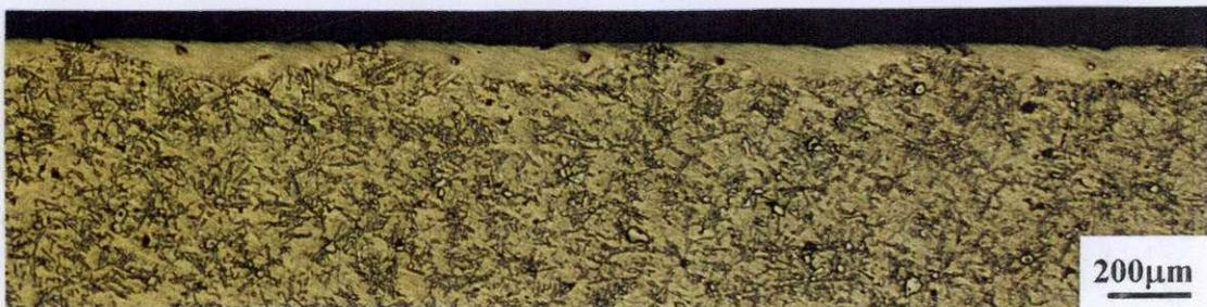
**Fig. 112** MO da seção transversal da área da liga de Al-Si (condição T5LF). Ataque: HF 5%
