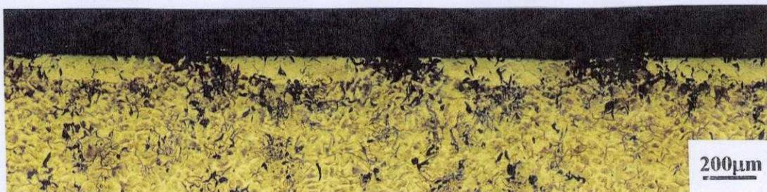
**Fig. 66** MO da seção transversal da área de ferro fundido (condição T2L4).Ataque: Nital 4%.
