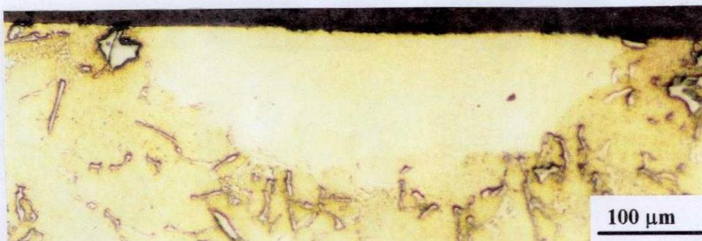
**Fig. 94** MO da seção transversal da área da liga de Al-Si (condição LE). Ataque: HF 5%.
