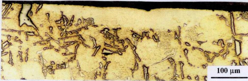
**Fig. 90** MO da seção transversal da área da liga de Al-Si (condição LA). Ataque: HF 5%.
