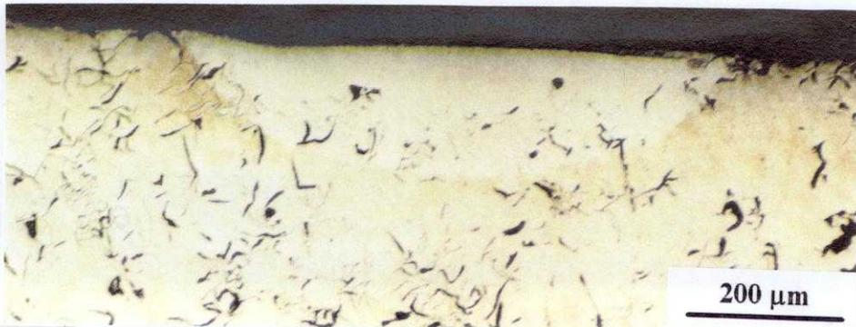
**Fig. 51** MO da seção transversal da área de ferro fundido (condição L1). Ataque: Nital 4%.
