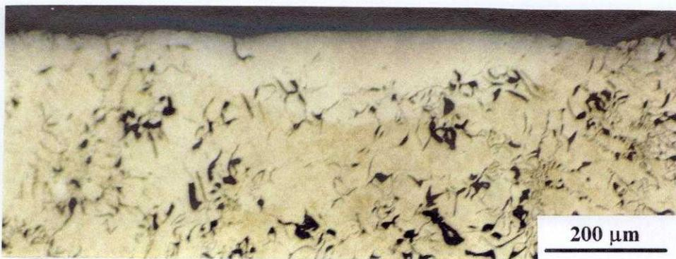
**Fig. 53** MO da seção transversal da área de ferro fundido (condição L3). Ataque: Nital 4%.
