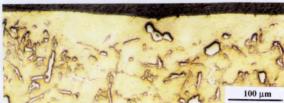
**Fig. 96** MO da seção transversal da área da liga de Al-Si (condição LG). Ataque: HF 5%.
