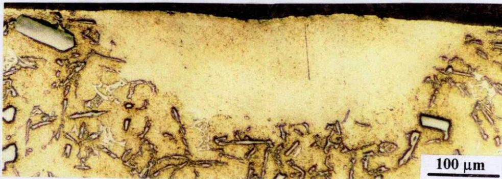
**Fig. 92** MO da seção transversal da área da liga de Al-Si (condição LC). Ataque: HF 5%.
