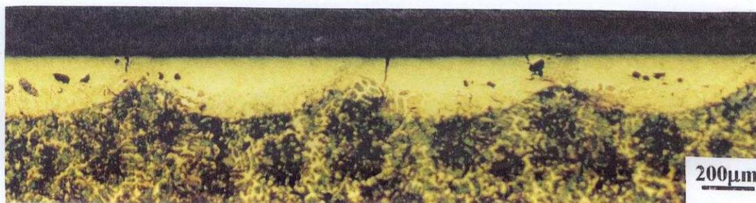
**Fig. 65** MO da seção transversal da área de ferro fundido (condição T1L2).Ataque: Nital 4%.
