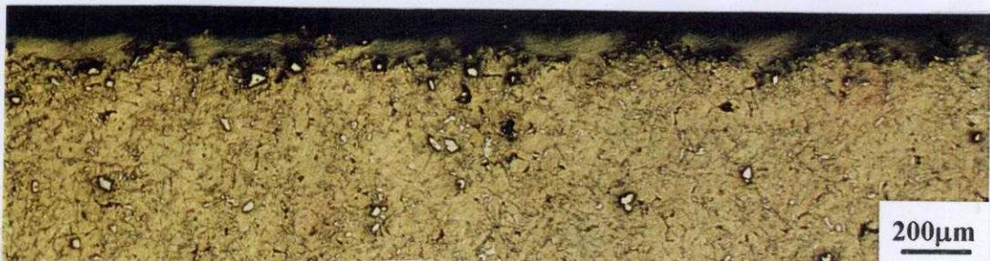
**Fig. 111** MO da seção transversal da área da liga de Al-Si (condição T4LE). Ataque: HF 5%
