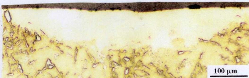
**Fig. 95** MO da seção transversal da área da liga de Al-Si (condição LF). Ataque: HF 5%.
