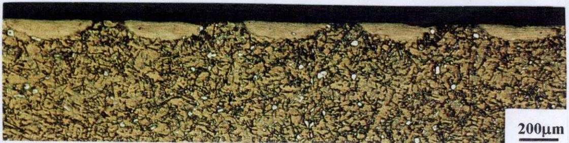
**Fig. 110** MO da seção transversal da área da liga de Al-Si (condição T3LD). Ataque: HF 5%
