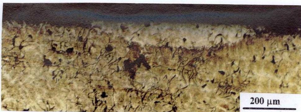
**Fig. 54** MO da seção transversal da área de ferro fundido (condição L4). Ataque: Nital 4%.
