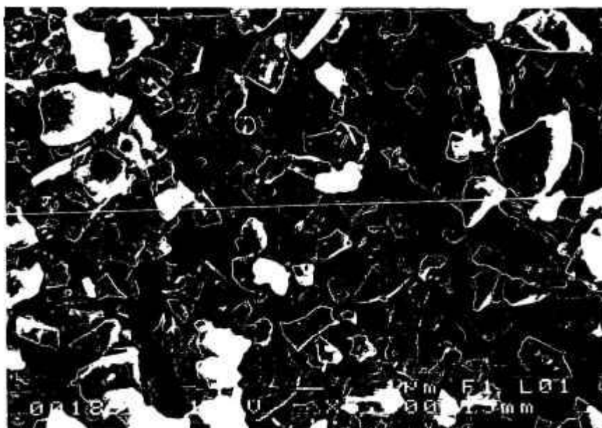
Figura 28 - Morfologia das partículas do pó MSS, MEV.
