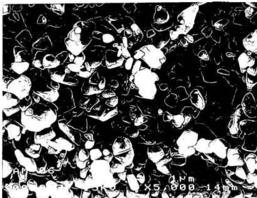
Figura 52 - Superfície de fratura do MSS sinterizado a 1500°C, MEV.
