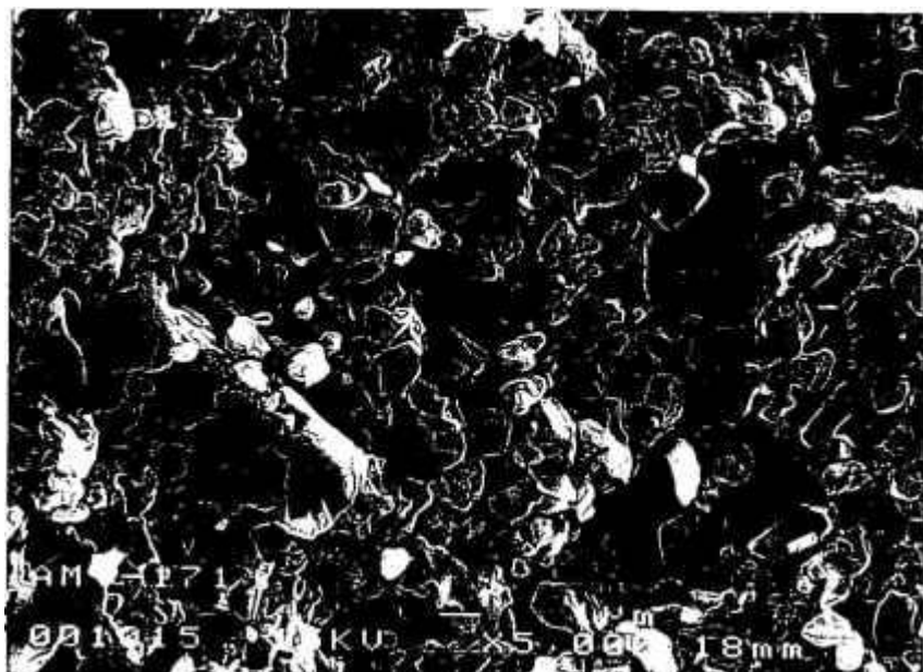
Figura 57 - Superfície de fratura do M com adição de 3% em peso de carbono sinterizado a 2000°C, MEV.
