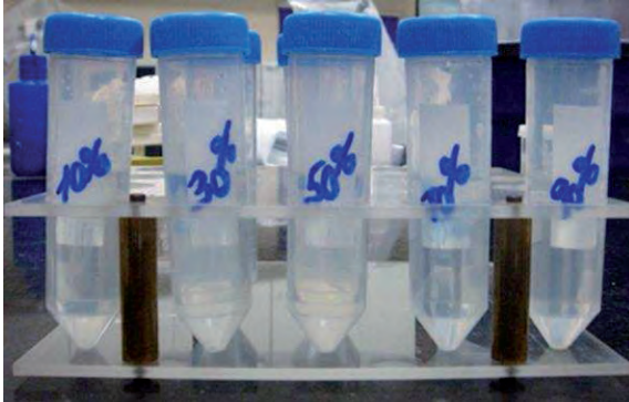
Figura 34. Muestras en soluciones crecientes de alcohol puro para deshidratación progresiva
