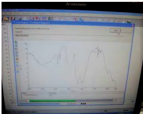
Figura 39. Obtención del espectro background , el cual será substraído en todos los espectros obtenidos por transformada de Fourier
