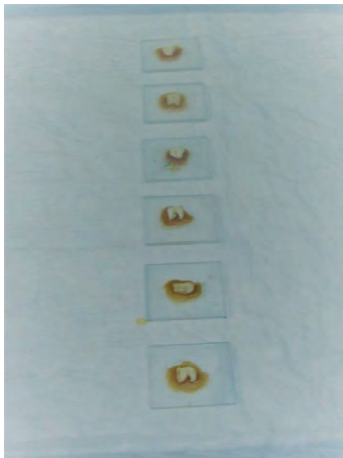
Figura 10. Distribución de las raíces dentaria fijas en la lámina de acrílico para el corte manual
