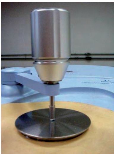
Figura 37. Análisis de las muestras por la técnica de reflexión total atenuada aplicándose una fuerza de torque de 130 N
