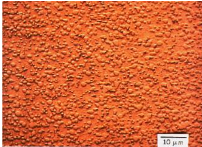
Figura 5: Estrutura do aço sinterizado 2,3%C-12,5%Cr-1,1%Mo-4,0%V, direção transversal. Carbonetos primários finos e distribuídos de forma homogênea. Ataque profundo, Nital 5%.
