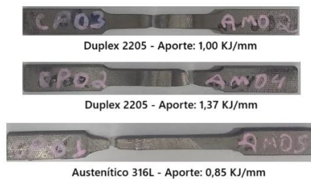
Figura 10 – Três corpos de prova rompidos no ensaio de tração
